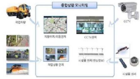
FIGURE 6- SYSTEME DE SURVEILLANCE DE LA SURFACE DE LA ROUTE
